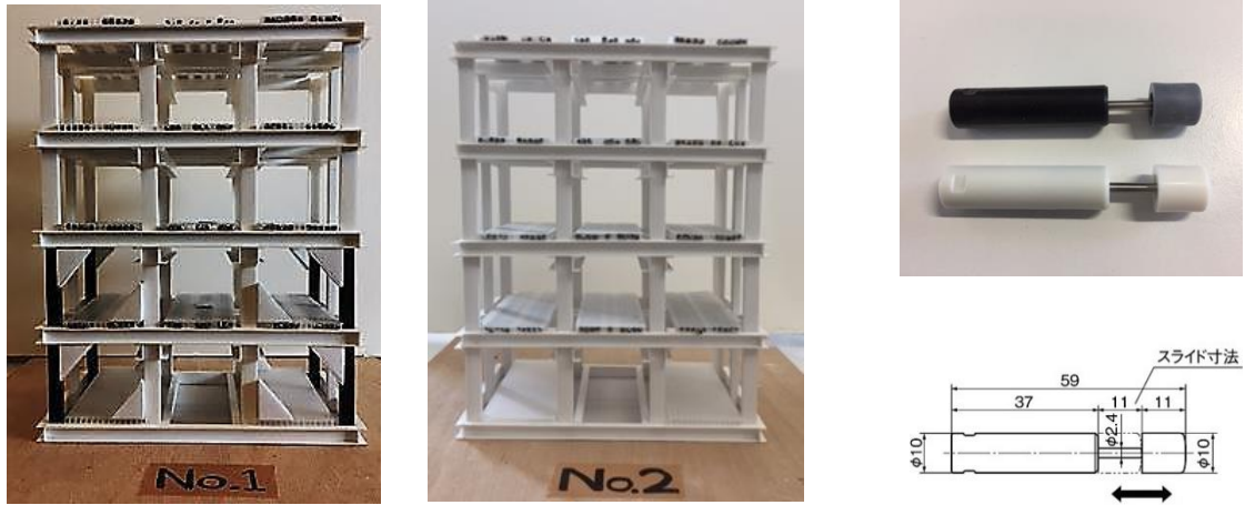
写真 1 スチレンボード製 スタディモデルと模型減衰装置
