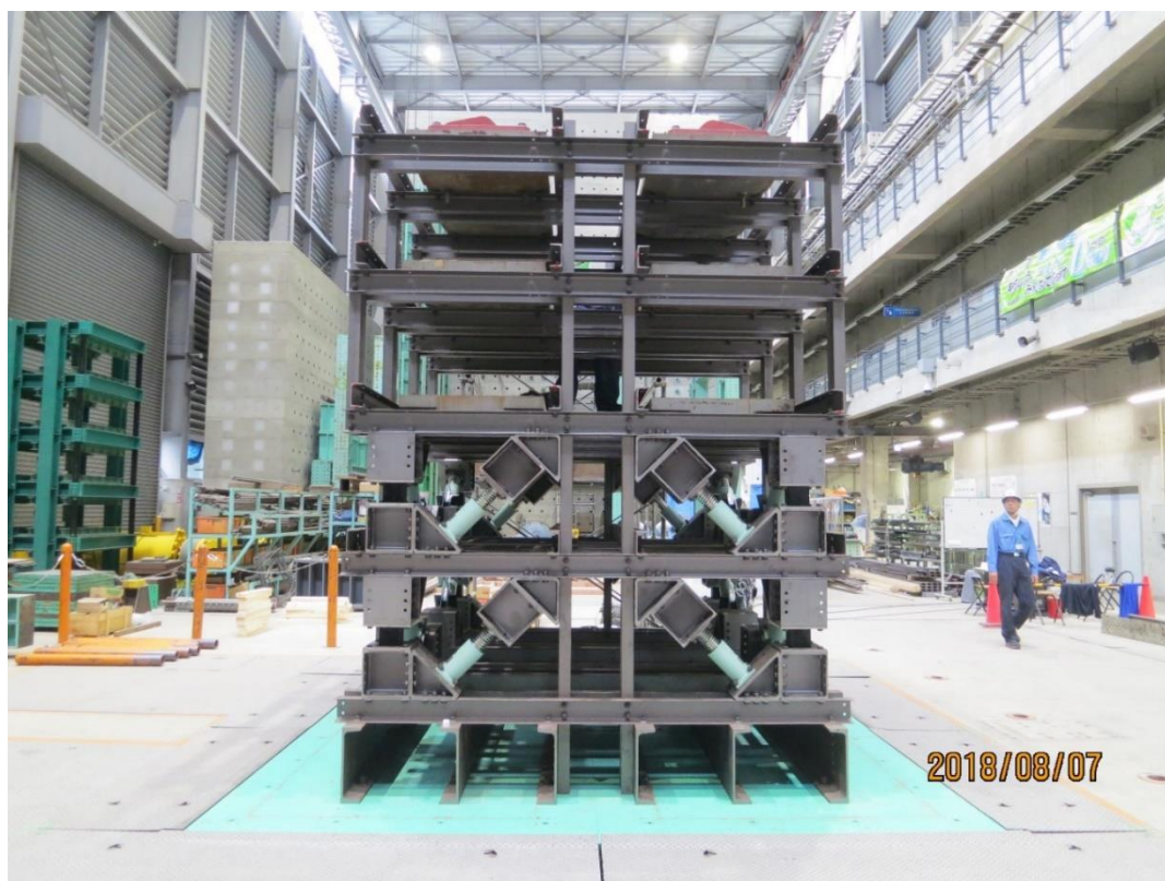
写真 2 東急建設技術研究所で行われた4層鋼構造新型制震構造システム振動台実験
