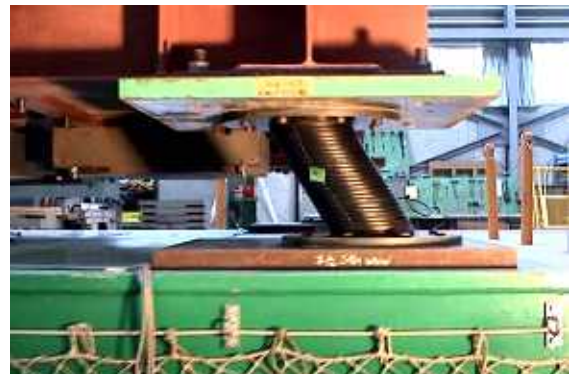
振動台実験中の積層ゴム支承の変形状態（撮影：東急建設）
