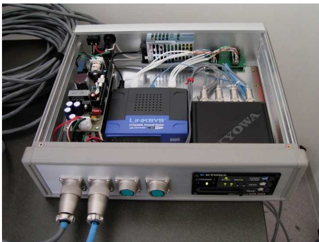
観測データロガーとLAN接続の様子
